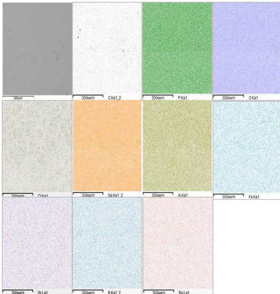
Рис. 10. Результаты картирования поверхности стекла, полученного в ИПХТ
