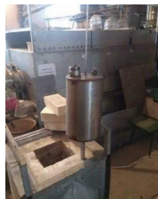
Рис. 2. Устройство приема и передачи отработанного электролита: печь (а), регулятор мощности (б), внутренний контейнер для расплава электролита (в)
